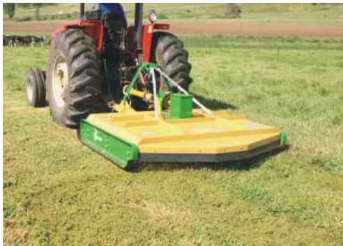
Die Falcon F80/200FM Fieldmulcher™ sny die gras, mulch dit en versprei dit eweredig oor die snywydte.
