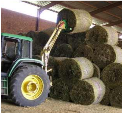
Die F750 Uniloader™ kan sowel ronde as vierkantige bale laai en stapel
